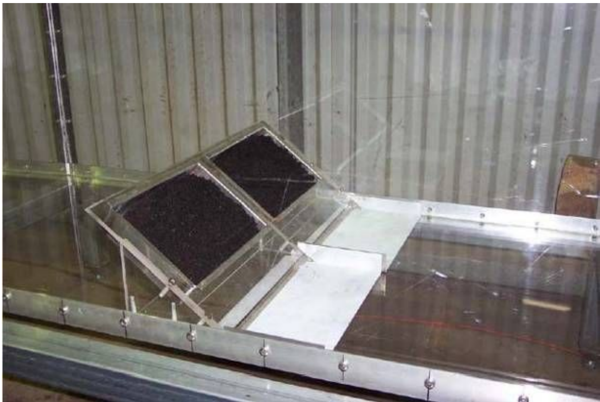
图一：配两个试样托盘的风洞
